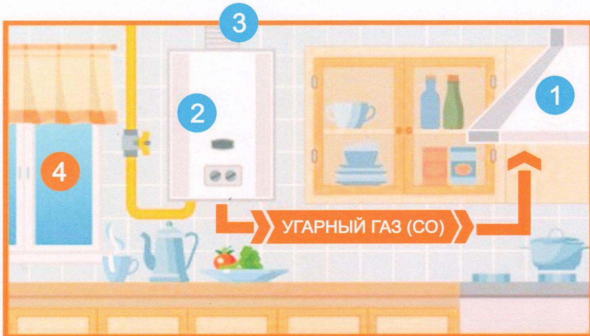
Если одновременно работает электровытяжка и газовый прибор (дымоходная газовая колонка или котел), то угарный газ, который образуется во время работы прибора, не выводится в дымоход, а поступает и накапливается в помещении. Это происходит из-за того, что электровытяжка, создавая обратную тягу, принудительно побуждает угарный газ поступать в помещение.
